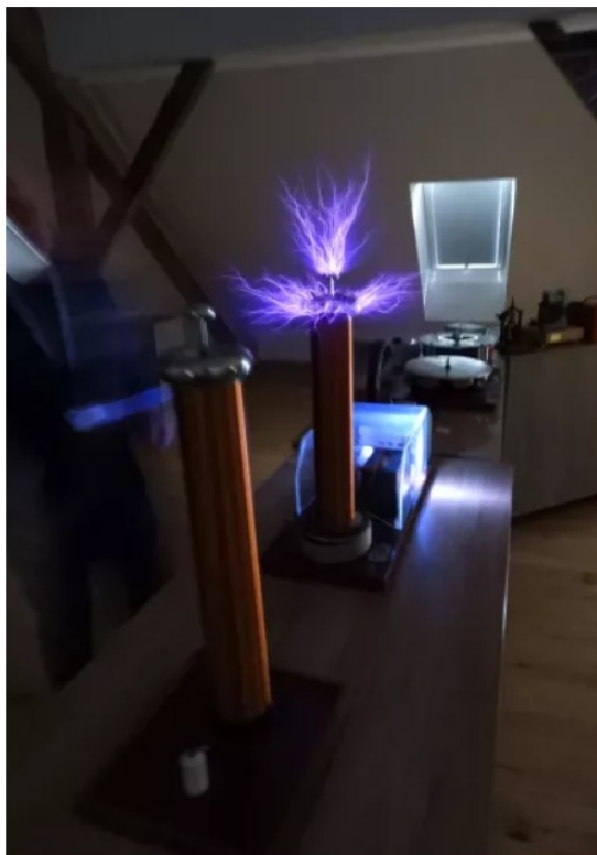
Teslov transformator omogoča brezžični prenos električne energije. / Foto: Katja Petrovec
